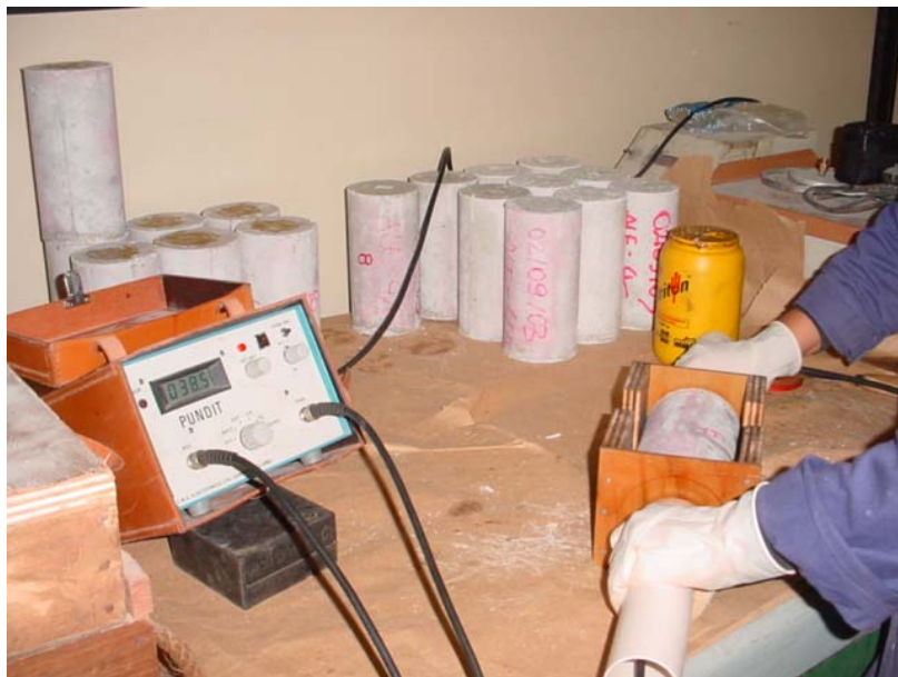
Figura 8 – Execução do Ensaio de Propagação do Pulso Ultra-Sônico.
